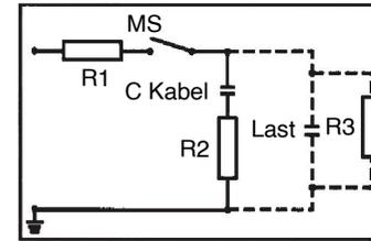
Bild 1: Schutz bei kapazitiven Lasten
