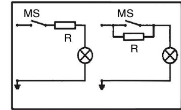
Bild 2: Lampenlast mit Parallel- oder Reihenwiderstand zum Schalter
