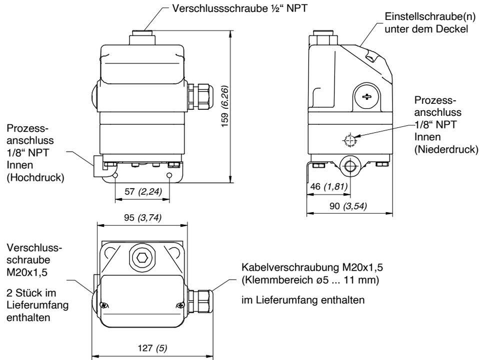
Bild 8: Metall-Membran-Differenz-Druckschalter Typ DPD1T .../DPD2T ...
