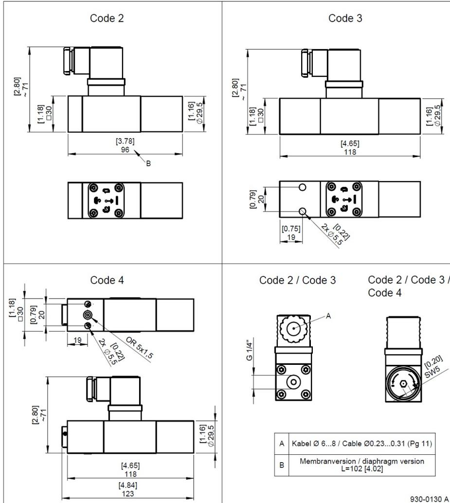
Bild 7: Kompakt-Druckschalter Typ Serie 9000, Standardversion
