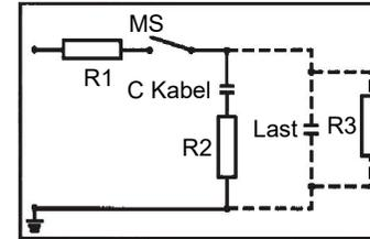
Bild 1: Schutz bei kapazitiven Lasten
