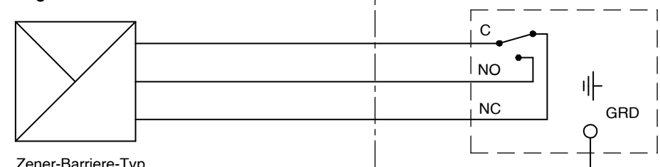
Bild 6: Betreiben von Temperaturschaltern in eigensicheren Bereichen
